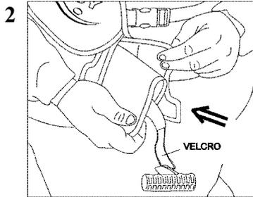
Stecken Sie die Beutel ins unaufgefüllte Jacket. Achten Sie darauf, dass die mit Plastik verstärkte Bleitaschenseiten innen anliegen.
