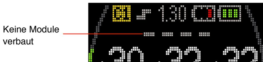
Ist weder eine Atemkalkanzeige verbaut noch ein CO<sub>2</sub> Sensor, dann wird '- - -' angezeigt.
