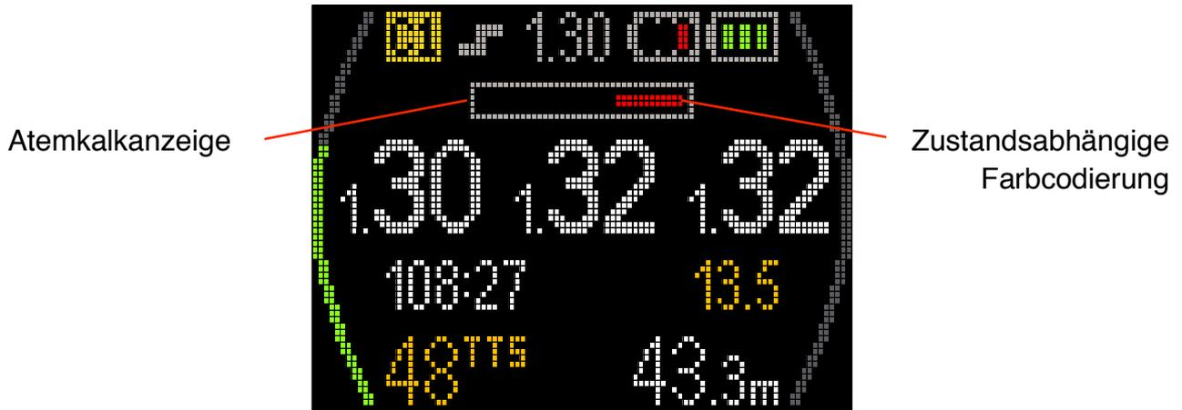
Die Atemkalkanzeige sieht genau wie auf der Armgelenksanzeige aus, aber mit dem zusätzlichen Vorteil einer zustandsabhängigen Färbung. Wenn die aktive Fläche des Kalks geringer wird, wechselt der Balken von grün auf rot, um dieses Problem hervorzuheben.
