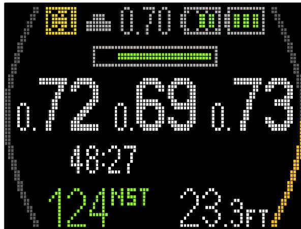
Erhöht sich die Aufstiegsgeschwindigkeit, verlängert sich der Balken in die Höhe und wird gelb, sobald die Aufstiegsgeschwindigkeit zwischen 5 und 10m/min beträgt.
